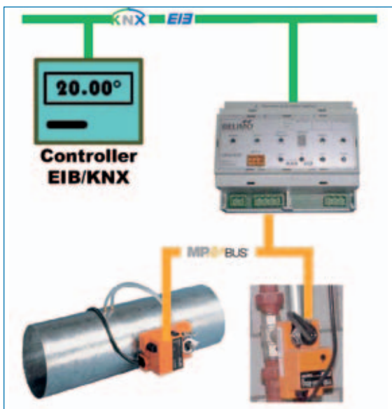
Bild 5: Ansteuerung von Brandschutzklappe über KNX-Bus mit dem Belimo-Gateway UK24EIB.
